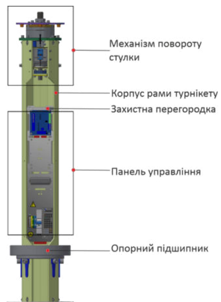
Рис.3 - Конструкція рами турнікету-хвіртки Gate STE
